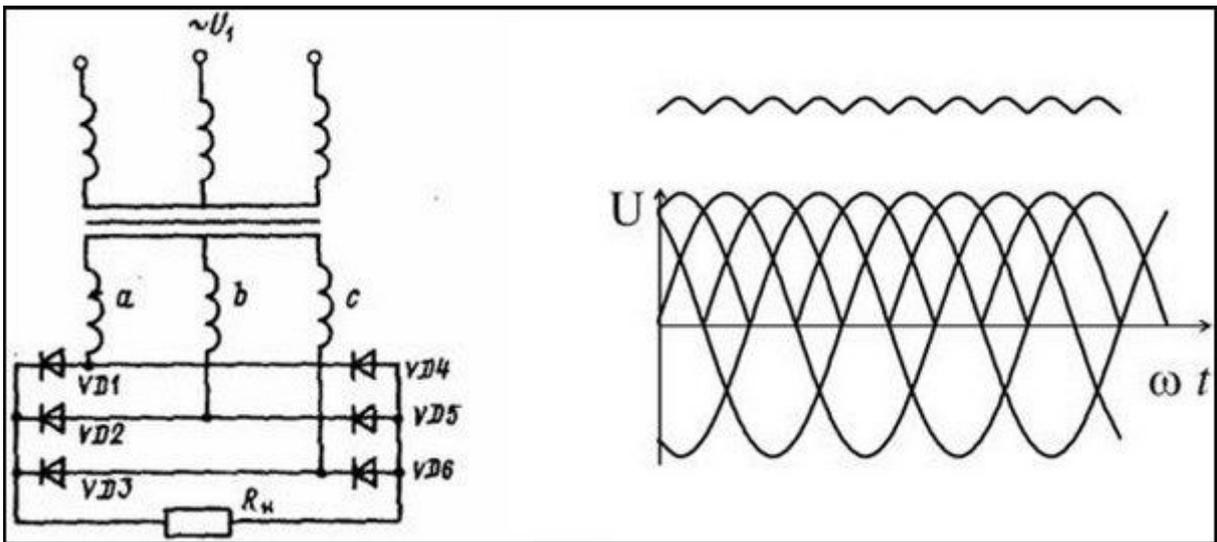
В приведённых схемах параллельно нагрузке может быть подключён конденсатор, который осуществляет сглаживание получаемого напряжения.
